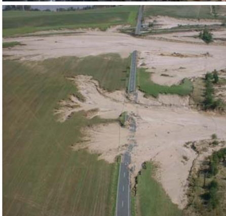
**Abbildung 11: Hochwasserschäden an Bahngleisen und Bundesstrassen**
