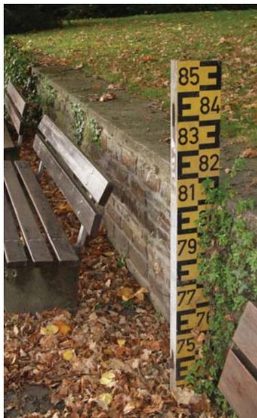
Abbildung 10: Pegelmesslatte zur Bestimmung des Wasserstandes
