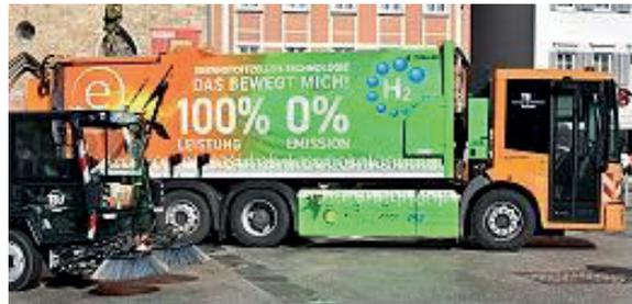
Abbildung 29: Brennstoffzellen-Müllsammelfahrzeug © TBR Reutlingen<sup>67</sup>
